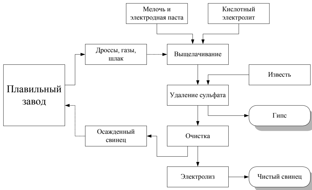
Диаграмма 4. Схема получения свинца электролитическим методом
