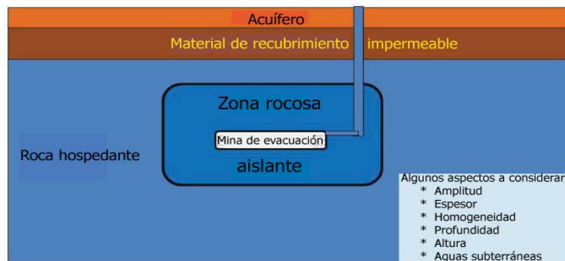
Figura 7: Concepto de la inclusión completa (diagrama esquemático) (cortesía de: GRS)
